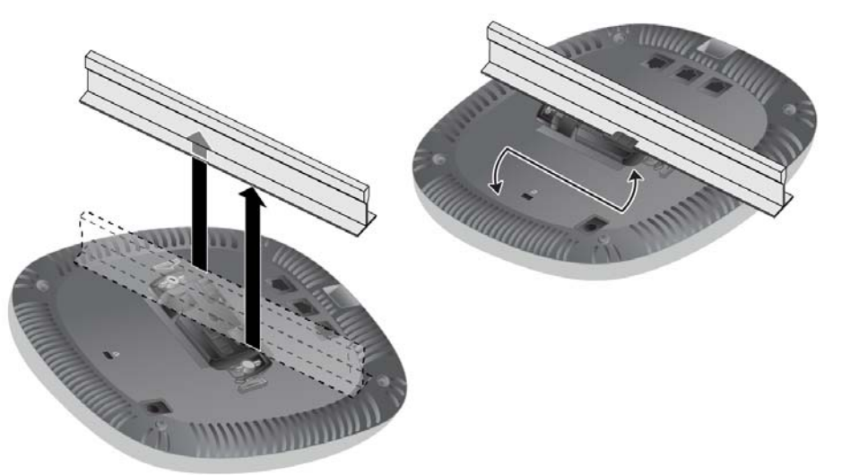
Şekil 7 Erişim Noktasının Montajı
