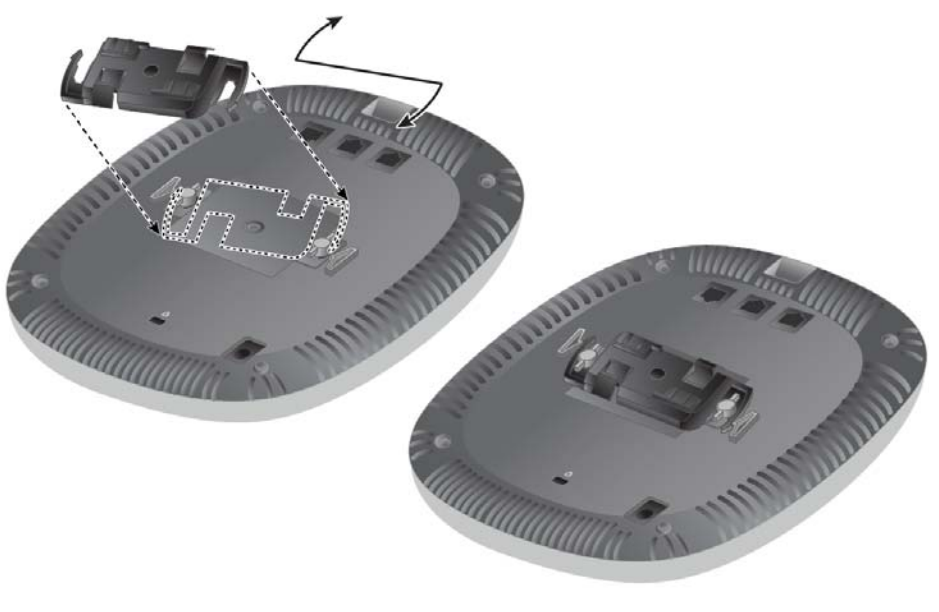
Şekil 6 Tavan Rayı Adaptörünün Takılması
